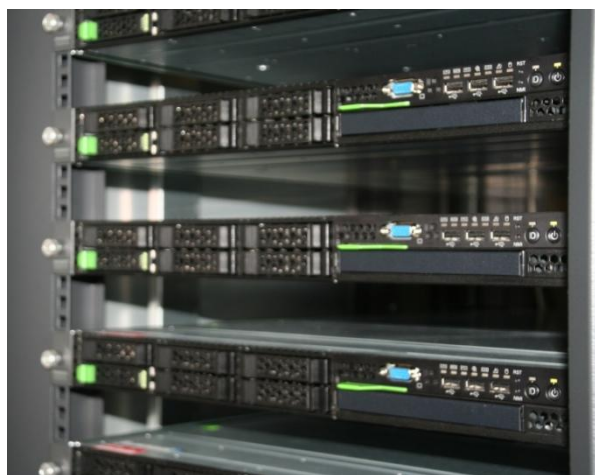
Počítačový cluster Sněhurka, čítající 104 procesorů s celkovou operační pamětí 300GB a 10TB úložného prostoru
