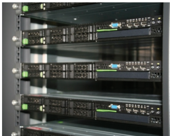
Počítačový cluster Sněžurka, čítající 104 procesorů s celkovou operační pamětí 300GB a 10TB úložného prostoru
